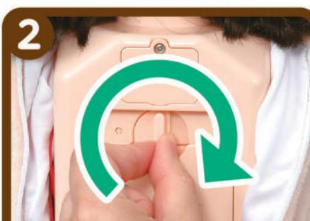
電池ふたを止めているロックバーをひねり、電池ふたを開けます。
